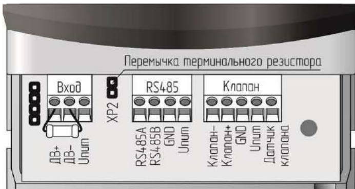
Рисунок В.2 – Расположение разъемов сигнализатора с одним RS485. Сигнализатор СЗ-2ЕВ не имеет разъема «Клапан».
